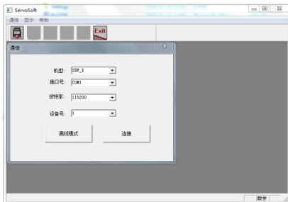
图 6-3 串口设置界面
